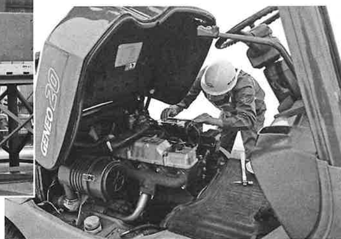
作業開始前点検
